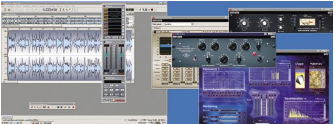
[01] MIT DEM WAVELAB WELLEN-EDITOR (LINKS) LÄSST SICH DIE WAVE-KURVE BEI BEDARF SAMPLEGENAU DARSTELLEN. PLUG-INS UND SIGNALWEGE WERDEN AUF DEM RECHTEN MONITOR DARGESTELLT
