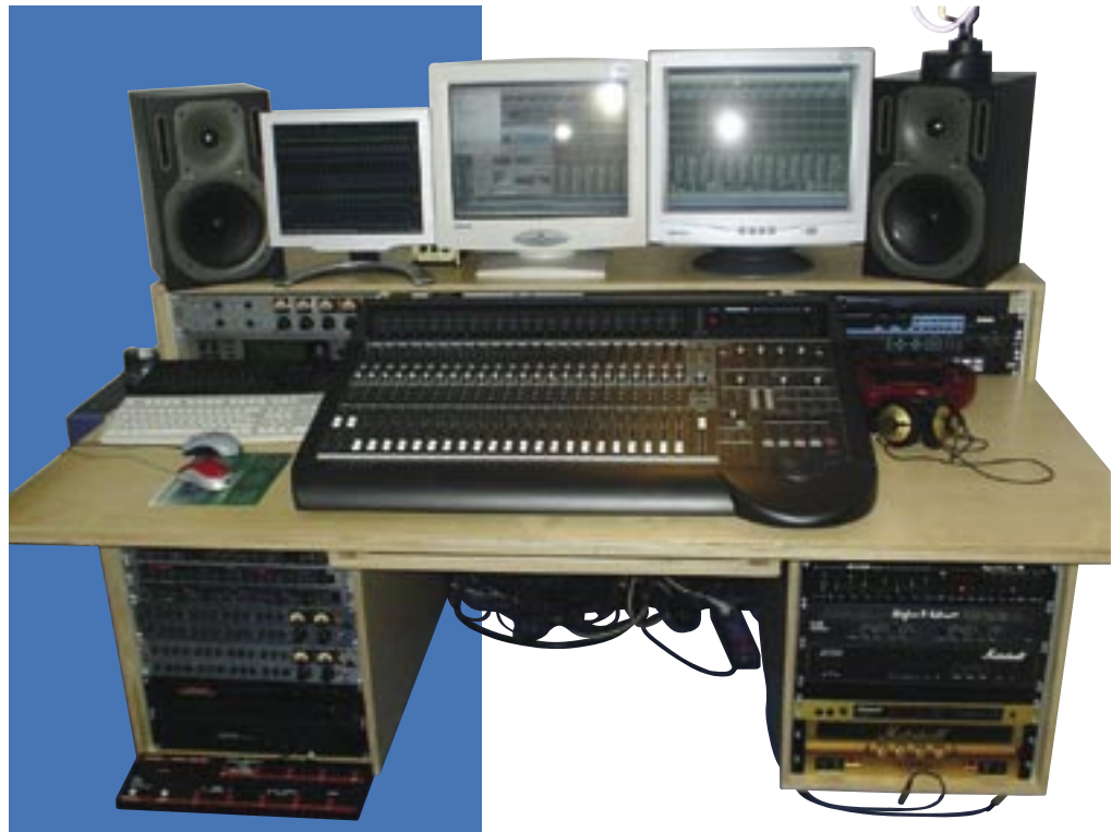
DIE TYPISCHE AUSSTATTUNG FÜR EINE HIGH-END-AUDIOPRODUKTION UMFASST UNTER ANDEREM EIN MACKIE DB8 MISCHPULT (BILDMITTE) MIT APOGEE CLOCK CARD SOWIE EIN 72-8-2-KANAL-DIGITALPULT
